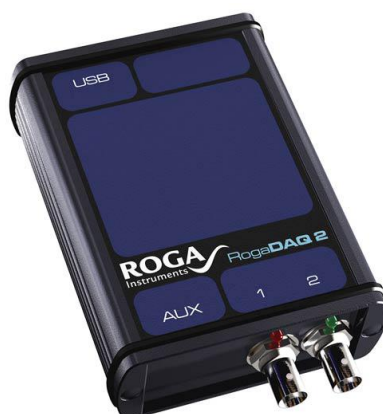
Figura 81: scheda professionale RODAdaq2 della ROGA-instruments, utilizza VA come software di base
