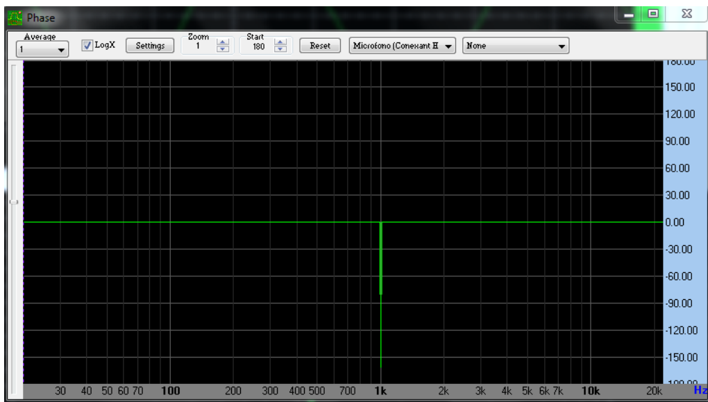
Figura 28: fase del segnale sinusoidale di fig. 7 con soglia impostata a -70 dB
